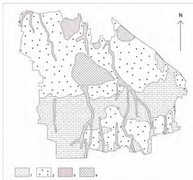
Figura 3 – Carta litologica del territorio comunale di Capurso (dalla Carta Tecnica dell'Italia Meridionale). Legenda: 1) calcari detritici a grana fine o micritici in strati e banchi, a luoghi stratiformi (localmente detti “chiancarelle”), con orizzonti bauxitici di estensione e potenza anche notevoli; 2) calcareniti organogene più o meno cementate, massicce o in banchi; 3) complesso sabbioso siltoso-argilloso con presenza di calcare incrostante in superficie, e terre argillose bruno-rossastre con pezzame e ciottoli calcarei, prevalenti nei solchi erosivi (“lame”); 4) centro abitato.
